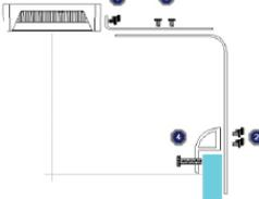
1. Realize o ajuste do suporte e instale a luminária no aquário fixando com o parafuso.
